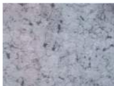
a Microestructura de un clavo de sección cuadrada con evidencias de proceso manual típico de los siglos XVIII y XIX.
